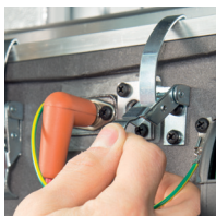
Sgancio "quick release" sistema di combustione
